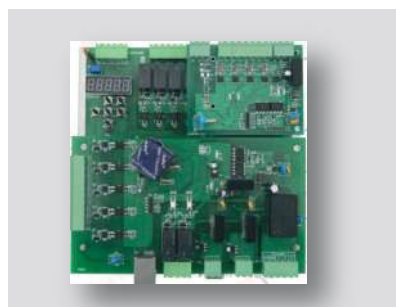
Sistema de control anti-balanceo de tercera generación
